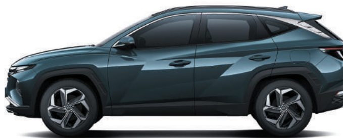
Габаритная длина 4630 Колесная база 2755
