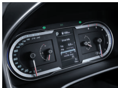
Панель приборов Supervision с 4,2-дюймовым TFT-экраном
